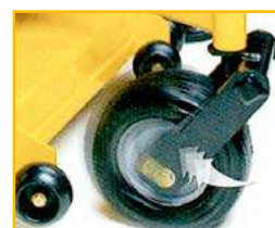
Suspensions Flex-Forks™ sur roues avant
