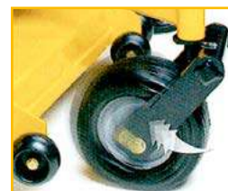
Suspensions Flex-Forks™ sur roues avant
