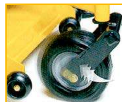
Suspensions Flex-Forks™ sur roues avant
