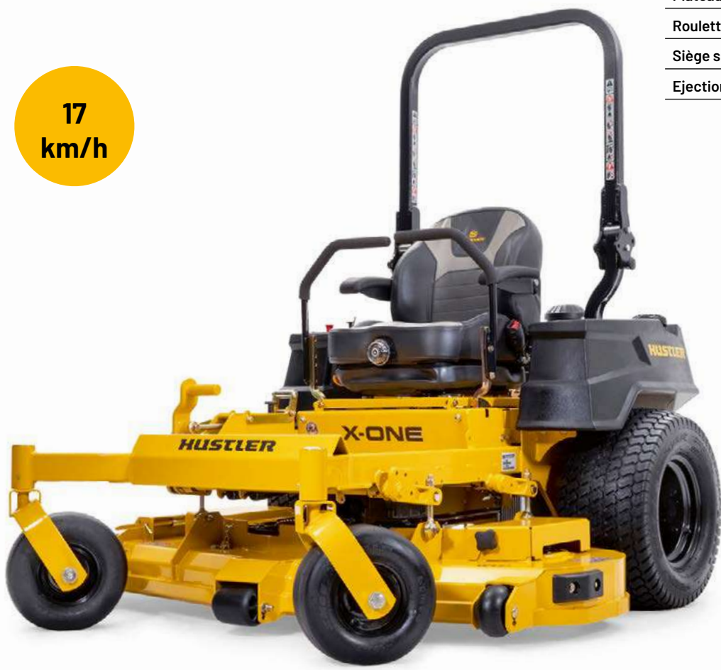
Suspensions Flex-Forks™ sur roues avant
